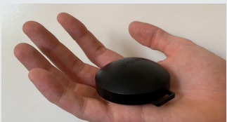
Das Radonexosimeter misst nur wenige Zentimeter und ist unkompliziert in der Handhabung. (Foto: NLWKN)
